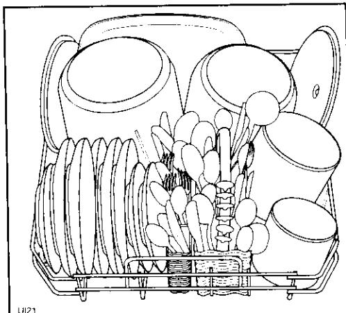
Столовые приборы ставятся в специально предназначенную для них корзину ручками вниз. Если же ручки настолько тонкие, что они проходят сквозь ячейки корзины, приборы следует поставить ручками вверх.
