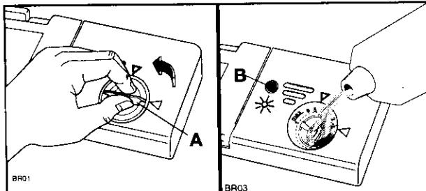
Плотно заверните пробку после каждого заполнения. Для того чтобы в процессе следующей за заполнением мойки не образовывалось пены, возможные остатки средства для полоскания, пролившиеся рядом с заполнительным отверстием, следует тщательно вытереть.
