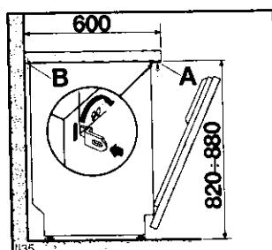
**ВНИМАНИЕ:** в случае крепления машины к кухонному элементу ни в коем случае не сверлите отверстий в боковых панелях машины, так как это приведёт к повреждению деталей, находящихся между корпусом и баком машины. Перед прикосновением к внутренним деталям машины вилку следует обязательно вынуть из розетки.
