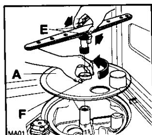
**ВНИМАНИЕ:** ни в коем случае не включайте машину без фильтров. В случае неправильной установки фильтров результат мойки окажется плохим. Чистка фильтров является важным условием надлежащего функционирования машины.
