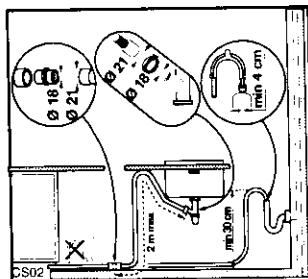
Удлинение шланга допускается не более чем на 2 м. Диаметр удлинительного шланга, а также диаметр возможного переходника должен быть не меньше диаметра сливного шланга машины.
