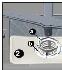
Отсоедините фильтр (a), затем извлеките из микрофильтра, фильтр грубой очистки. Промойте его под большим количеством теплой воды из-под крана. Соберите фильтр в обратной последовательности.
