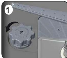
Используйте умягчающие соли, которые специально произведены для использования в посудомоечных машинах. Для добавления соли, отвинтите крышку против часовой стрелки. Засыпьте 1 кг., соли и долейте воду до уровня. После этого установите на место крышку, закрутив по часовой стрелке.
