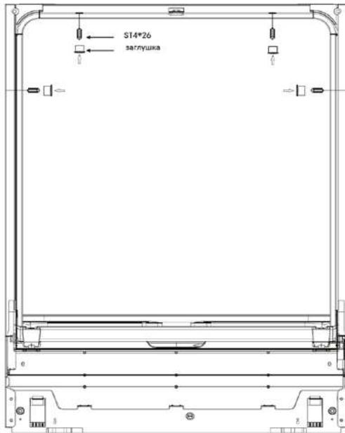
В обшивке посудомоечной машины с правой и левой стороны, а также сверху имеются 4 отверстия. Для крепления посудомоечной машины к кухонному модулю используйте деревянные винты ST4\*26 (соответствующие самонарезающие винты!).
