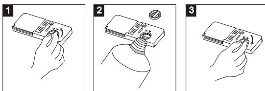
1) Открыть дозатор; повернуть колпачок в направлении стрелки (влево) "open" [открыто] и поднять его.
