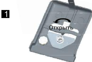
Этап 1: отвернуть фильтр грубой очистки против часовой стрелки.
