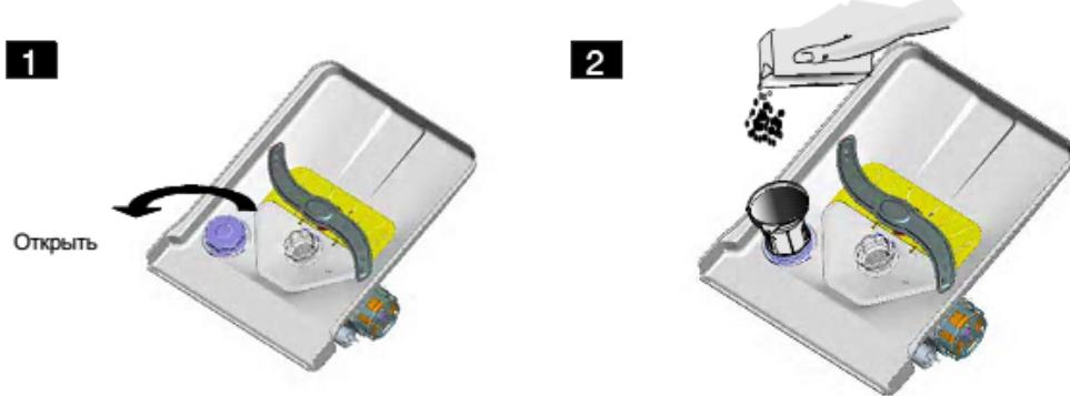
**A** Извлечь нижнюю корзину, а затем отвинтить и снять крышку с контейнера соли. 1
