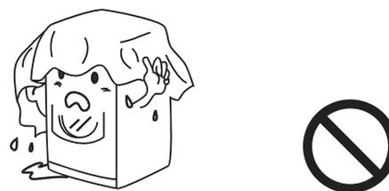
14. Не помещайте тяжелые предметы, нагревательные приборы или емкости с водой на верхнюю панель стиральной машины.
