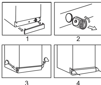
5. Регулярно проводите чистку отверстия для подачи воды и водопроводного фильтра, чтобы предотвратить блокировку подачи воды с посторонними объектами/ субстанциями.
