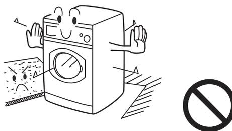
10. Чтобы продлить срок службы пластиковых и резиновых компонентов, не подвергайте стиральную машину воздействию прямого солнечного света и нагревательных приборов.
