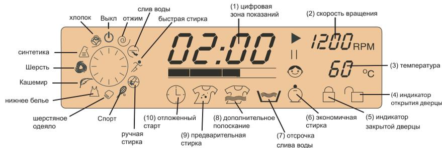
1. Цифровая зона показаний: когда машина включается, на ней показывается установленное время для стирки. Когда запущена программа стирки, на ней показывается оставшееся время до завершения. Когда включена функция блокировки кнопок, в цифровой зоне отображается индикатор "SAFE ON"; после отмены этой функции появляется индикатор "SAFE OFF". По окончании процесса стирки в цифровой зоне появляется индикатор "End".
