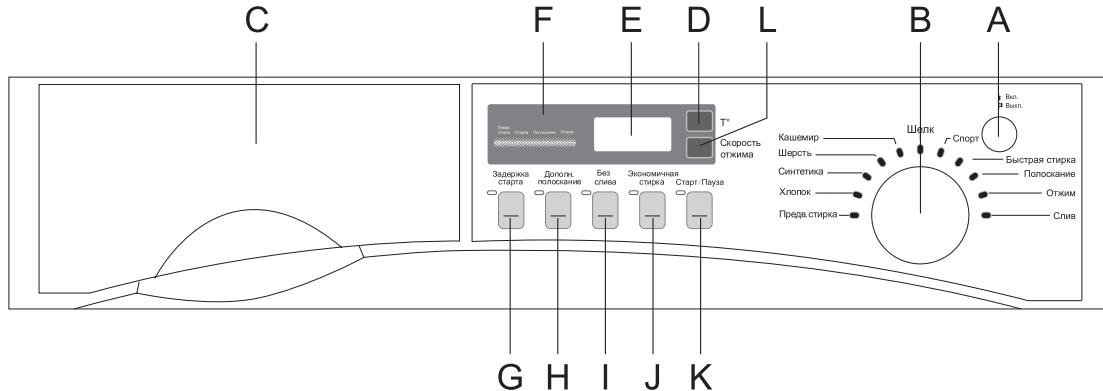
А — кнопка включения или выключения стиральной машины.
