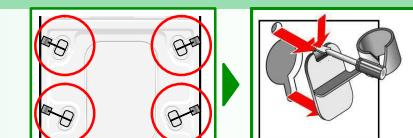
2. Вставьте 4 втулки. Сетевой кабель закрепите в держателях. Вставьте винты и затяните их.
