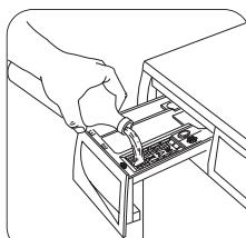
Вытяните до упора дозатор моющих средств. Отмерьте нужное количество моющего средства, засыпьте его в отделение основной стирки дозатора **1**, и, если Вы желаете выполнить предварительную стирку или вымачивание, засыпьте его в отделение, помеченное символом **2**.
