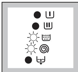
Ebben az esetben a mosógép az öblítést és centrifugálást fogja végrehajtani.
