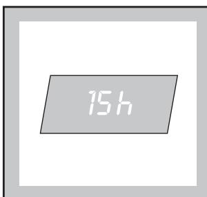
A késleltetett idő 3 másodpercre kerül kijelzésre, majd pedig a beállított program időtartama fog újra feltűnni. Miután benyomta az INDÍTÁS/SZÜNET gombot, elkezdődik a visszaszámlálás, melynek értéke óránként csökken.
