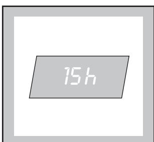
Na displeji se objeví asi na 3 sekund číslice označující požadované zpoždění. Poté se opět zobrazí doba trvání nastaveného programu. Po stisknutí tlačítka START/PAUZA začíná přístroj odpočítávat čas (v celých hodinách). Spuštění programu můžete oddálit max. o 23 hodin, v hodinových intervalech.
