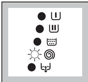
V tomto případě bude vykonána funkce "drain" (vypuštění vody) i "spin" (odstředování), a to rychlostí podle nastaveného typu prádla.
