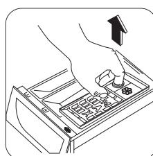
Для облегчения чистки можно снять верхнюю часть отделения для добавок. Извлеките дозатор, отжав вниз защелку и потянув его на себя. Промойте его под краном, чтобы удалить все остатки скопившегося в нем порошка.
