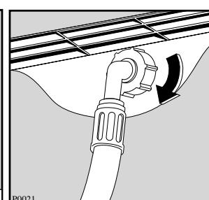
Другой конец наливного шланга, подключающийся к машине, может быть повернут в любом направлении. Ослабьте гайку, поверните шланг и вновь затяните гайку, проверив отсутствие течей воды. Наливной шланг нельзя вытягивать. Если он слишком короткий, и вы не хотите передвигать кран, то
