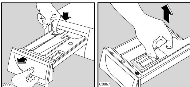
Стиральный порошок скапливается и в углублении дозатора. Для чистки углубления можно использовать старую зубную щетку.
