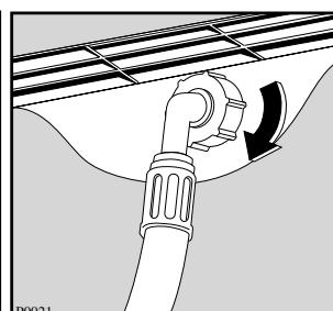
Другой конец наливного шланга, подключающийся к машине, может быть повернут в любом направлении. Ослабьте гайку, поверните шланг и вновь затяните гайку, проверив отсутствие течи воды. Наливной шланг нельзя вытягивать. Если он слишком короткий, и вы не хотите передвигать кран, то
