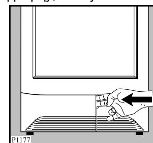
Для того, чтобы вытащить конденсатор следует повернуть два красных диска вниз и вынуть его держка за ручку.
