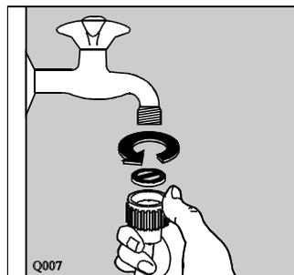
Подключение следует производить к холодной воде. Давление воды должно быть 0,1-1 МПа (1-10 bar).
