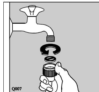
**Важно:** Не забудьте вставить резиновую прокладку в переходник 3/4"-1/2" и стопорную гайку (если это потребуется). Наливной шланг нельзя удлинять. Если он слишком короткий, замените весь шланг более длинным шлангом высокого давления.
