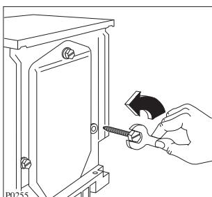
При помощи гаечного ключа удалите правый болт на задней стенке машины. Осторожно положите машину на заднюю стенку, стараясь не пережимать шланги. Проложите между машиной и полом пенопластовый упаковочный уголок.
