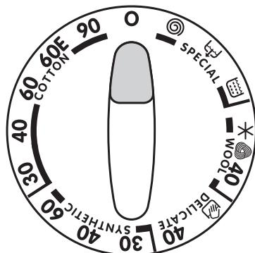
Для выбора одной из специальных программ, или выбора программы стирки и температуры согласно этикетке на одежде, поверните селектор программ в нужное положение по- или против часовой стрелки.
