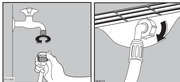
Другой конец наливного шланга, подключающийся к машине, может быть повернут в любом направлении. Ослабьте гайку, поверните шланг и вновь затяните гайку, проверив отсутствие течией воды. Наливной шланг нельзя вытягивать. Если он слишком короткий, и вы не хотите передвигать кран, то вам следует купить новый, более длинный шланг, специально предназначенный для данных целей.
