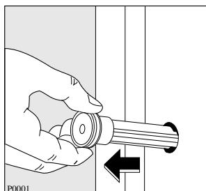
4. Установите машину в вертикальное положение и удалите три пластмассовых болта.
