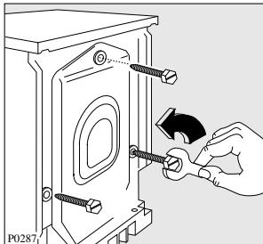
1. Отверните ключом и удалите три винта с задней панели машины.
