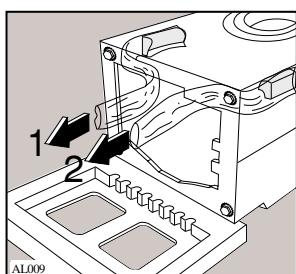
3. Осторожно снимите два полиэтиленовых пакета справа и слева, вытягивая их к центру прибора.
