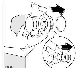
5. Закройте 3 отверстия пластмассовыми заглушками, которые содержатся в пакете с руководством по эксплуатации.
