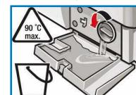
3. Осторожно отверните крышку насоса (остаточная вода!).
