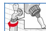
5. Промойте сетчатый фильтр: отсоедините шланг от водопроводного крана. Очистите фильтр небольшой щеткой.
