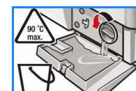
3. Осторожно отверните крышку насоса (остаточная вода!).
