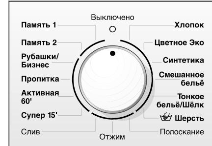
**i** Ручка выбора программ для включения и выключения машины и установки программ. Можно поворачивать в обоих направлениях.
