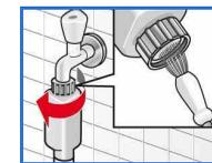
5. Промойте сетчатый фильтр: Отсоедините шланг от водопроводного крана. Прочистите фильтр с помощью щеточки.
