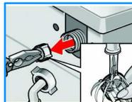
2. Присоедините шланг и проверьте места соединения на герметичность.
