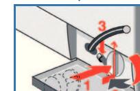
5. Установите крышку насоса на место и заверните. Ручка должна быть установлена вертикально. Вставьте сливной шланг в держатель.
