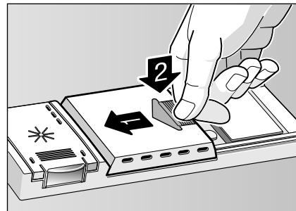
В случае применения таблеток, прочтите, пожалуйста, на упаковке изготовителя, куда следует кладь таблетки (напр., в ящик для столовых приборов, камеру для моющего средства и т.д.). Следите за тем, чтобы крышка камеры для моющего средства была закрытой также при применении таблеток.
