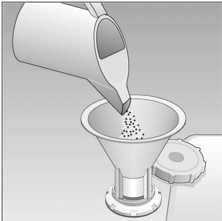
Индикация "Добавление соли для смягчения воды" **4** на панели сначала загорится и потухнет только тогда, когда концентрация соли в воде будет достаточно высока.
