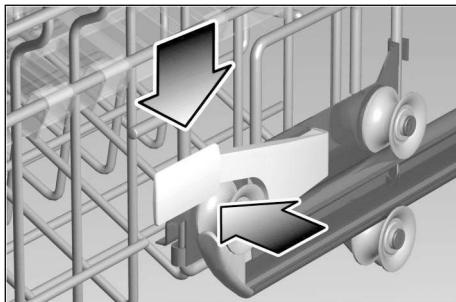
– Для того чтобы опустить корзину, вдавите один за другим оба фиксатора, расположенные слева и справа с наружной стороны корзины. При этом следует каждый раз крепко держать корзину рукой за край. Тем самым Вам удастся предотвратить внезапное падение корзины вниз (и «спастись» посуде от повреждения, если она уже была загружена в корзину).
