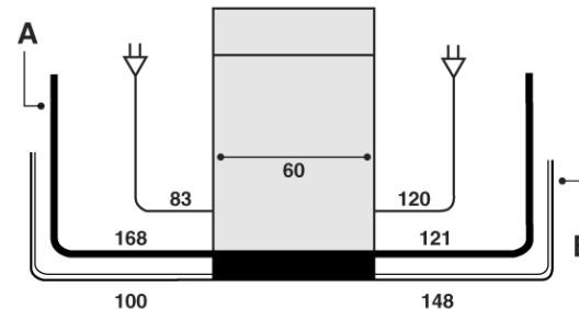
Для удобства установки заливной (A) и сливной (B) шланги, а также питающий кабель могут подсоединяться и с правой, и с левой сторон оборудования (см. рис.).
