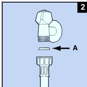
Если машина подключается к новому водопроводу или долго не использовалась, отверните шланг со стороны машины, слейте грязную воду и восстановите соединение. Это предохранит машину от повреждений.
