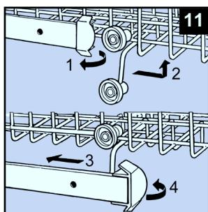
Положение верхней корзины регулируется по двум направляющим (верхней и нижней). Чтобы изменить положение верхней корзины, следуйте схеме на рис. 11:
