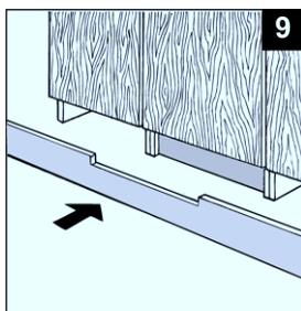
При размещении оборудования в углу комнаты возможен вариант поставки посудомоечной машины с кронштейнами для крепления нижней декоративной панели. В этом случае поместите металлический кронштейн на место его установки, и для ровного крепления декоративной панели отрегулируйте величину выступа кронштейна (рис. 10). Закрепите кронштейн, используя уголки (рис. 11). Поместите посудомоечную машину на установочное место и закрепите декоративную панель на кронштейне (рис. 12).
