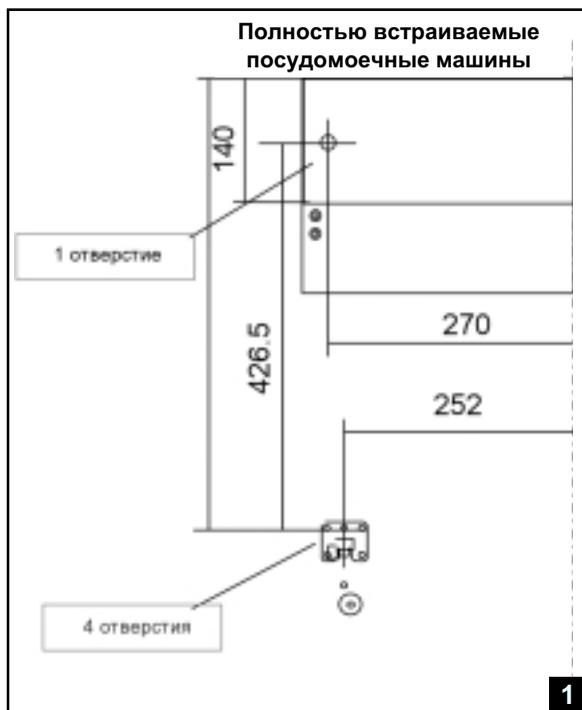
Если панель имеет неподходящие размеры, ее необходимо обрезать. Специалисту, производящему установку, необходимо следовать приведенным ниже инструкциям для закрепления панели на двери машины. Размеры крепежных панелей представлены на рис. 1.
