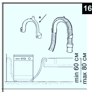
Если сливной шланг встроен в канализацию, имейте ввиду, что на верхних этажах может создаваться «сифонный эффект» — машина одновременно сливает и заливает воду. Для предотвращения подобного эффекта устанавливается сифон.
