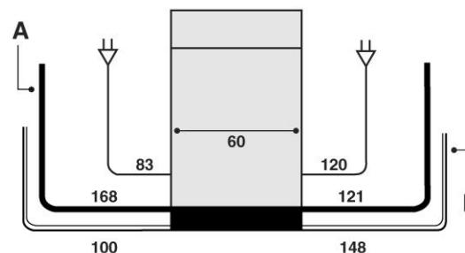
Для удобства установки заливной (A) и сливной (B) шланги, а также питающий кабель могут подсоединяться и с правой, и с левой стороной оборудования (см. рис.).
