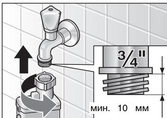
Накидные пластиковые гайки затягивайте только вручную. Не отделяйте сетку от шланга подачи воды.
