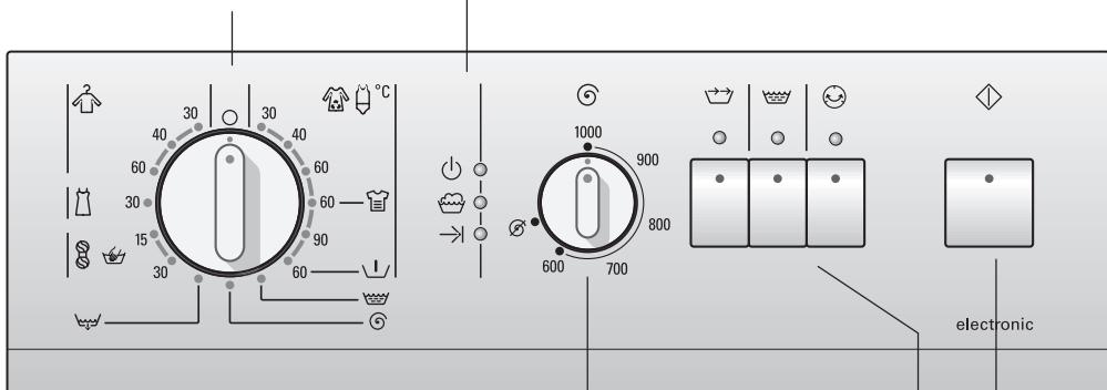
3. Число оборотов центрифуги регулируется (если есть желание) бесступенчато; напротив «∅» ручка должна зафиксироваться.
