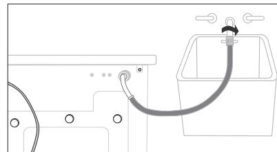
2. Подсоедините другой конец шланга для подачи воды к крану холодной воды, и затяните соединение рукой. В случае необходимости, вы можете изменить положение конца шланга для подачи воды, подключенного к стиральной машине, для чего ослабьте фитинг, поверните шланг и вновь затяните фитинг.
