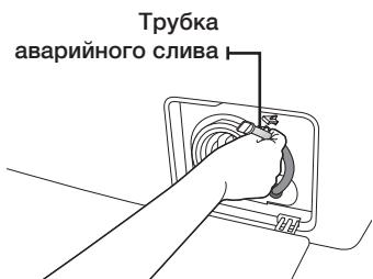
4. Снимите заглушку, закрывающую отверстие трубы аварийного слива.
