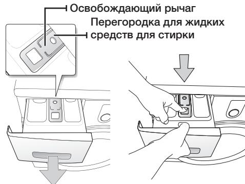
3. Промойте все части отсека проточной водой.
