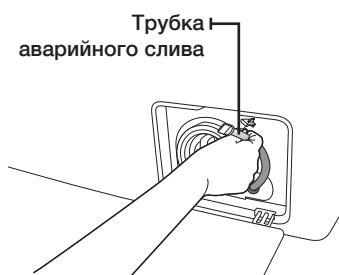
4. Снимите заглушку, закрывающую отверстие трубы аварийного слива.
