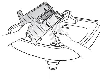
4. Очистите нишу для отсека с помощью старой зубной щётки.
