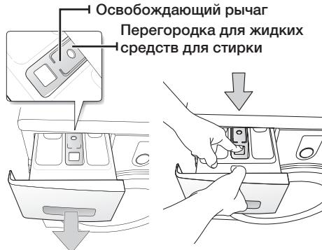
3. Промойте все части отсека проточной водой.
