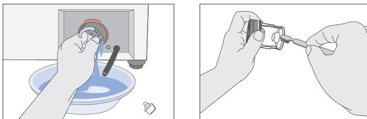
4. Смойте грязь и удалите другой мусор из фильтра. Убедитесь в том, что расположенные сзади фильтра лопасти сливного насоса не заблокированы грязью. Верните на место крышку фильтра.
