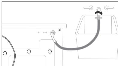
2. Подсоедините другой конец шланга для подачи воды к крану водопроводной системы и затяните соединение рукой. В случае необходимости, вы можете изменить положение конца шланга для подачи воды, подключенного к стиральной машине, для чего ослабьте фитинг, поверните шланг и вновь затяните фитинг.
