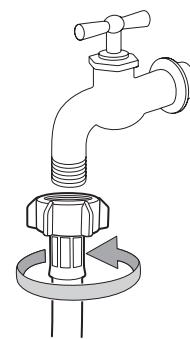
Для подачи воды используйте наиболее удобный для этой цели водопроводный кран. В случае, если кран имеет квадратную форму или слишком большой диаметр, извлеките промежуточное кольцо, прежде чем подсоединять адаптер к водопроводному крану.
