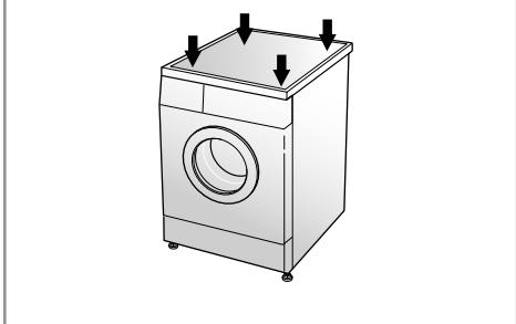
1. Для предотвращения вибрации и чрезмерного шума необходимо придать стиральной машине строго горизонтальное положение. Стиральную машину следует устанавливать на твердом, ровном полу, желательно в углу комнаты.
