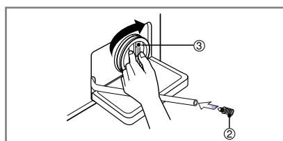
4. После чистки поверните фильтр (3) по часовой стрелке и вставьте на место дренажную пробку (2). Закройте дверцу на нижней панели.
