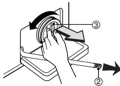
2. Выньте дренажную пробку (②), чтобы остатки воды стекли. Подставьте какой-нибудь сосуд, чтобы вода не попала на пол. Когда вода перестанет течь, откройте фильтр дренажного насоса (③), повернув его против часовой стрелки.
