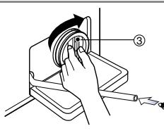
4. После чистки поверните фильтр (③) по часовой стрелке и вставьте на место дренажную пробку (②). Закройте дверцу на нижней панели.
