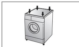
✳ **Зафиксируйте отрегулированные ножки, закрутив фиксирующую гайку против часовой стрелки.**
