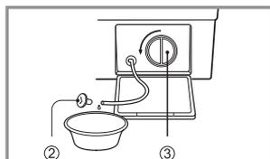
3. Выньте все посторонние предметы из фильтра (3). После чистки поверните фильтр (3) по часовой стрелке и вставьте на место дренажную пробку (2). Закройте дверцу на нижней панели.
