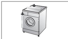
1. В целях предотвращения вибрации и чрезмерного шума необходимо установить стиральную машину строго в горизонтальном положении на твердом, ровном полу, желательно в углу комнаты.
