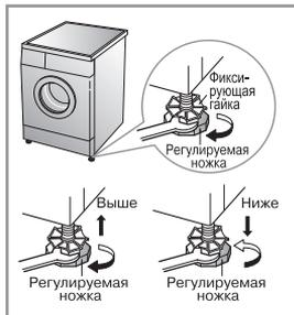
**ЗАМЕЧАНИЕ** В случае, если машина установлена на возвышении, ее следует надежно закрепить для того, чтобы исключить вероятность её падения.
