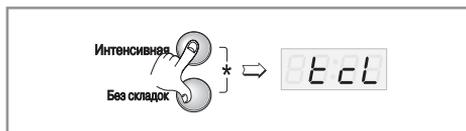
Режим **Очистка барабана** предназначен для очистки барабана стиральной машины. При данном режиме используется большое количество воды, а также устанавливается высокая скорость вращения барабана. Используйте этот цикл регулярно.
