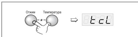
Режим **Очистка барабана** предназначен для очистки барабана стиральной машины. При данном режиме используется большое количество воды, а также устанавливается высокая скорость вращения барабана. Используйте этот цикл регулярно.
