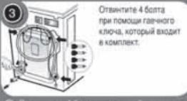
3 Отвинтите 4 болта при помощи гаечного ключа, который входит в комплект.
