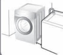
**Горизонтальный пол:** Допустимый наклон пола под стиральной машиной 1°.
