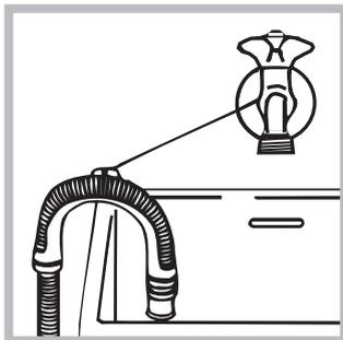
Повесьте загнутый конец сливного шланга на край раковины, ванны, или разместите в специальный вывод канализации. Шланг не должен перегибаться. Верхняя точка сливного шланга должна находиться на высоте 65-100 см от пола. Расположение сливного шланга должно обеспечивать разрыв струи при сливе (конец шланга не должен быть опущен в воду). В случае крепления на край ванной или раковины, шланг вешается с помощью направляющей (входит в комплект поставки), которая крепится к крану (рис.).
