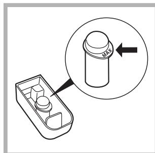
1 распределителя моющих средств. Не заполняйте лоток 4 выше отметки max (см. рис.).
