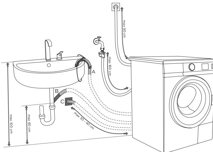
**A** Сливной шланг можно закрепить на раковине или ванне. При помощи шнура, протянутого через пластмассовый кронштейн, закрепите сливной шланг таким образом, чтобы он не соскользнул на пол.
