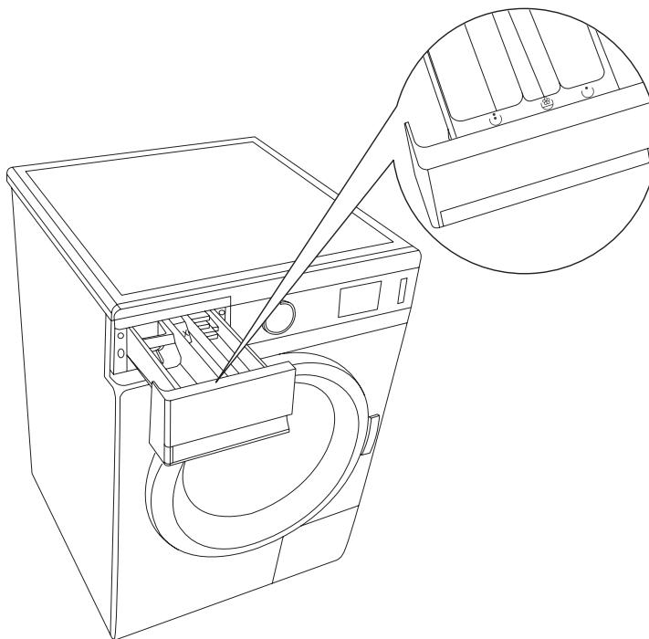
В дозаторе некоторых моделей стиральных машин предусмотрена специальная пластинка, которая позволяет заливать в левое отделение дозатора жидкие стиральные средства (в зависимости от модели). Если вы используете стиральный порошок, пластина должна быть поднята вверх. Если вы используете жидкие стиральные средства, опустите пластиночку.
