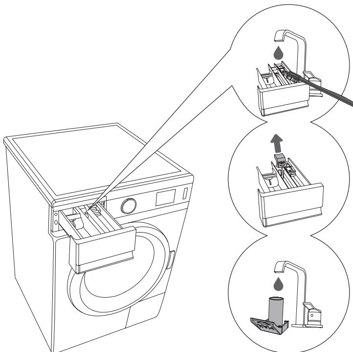
**1** Очистите дозатор щеткой под проточной водой, затем высушите его. Смойте остатки стиральных средств со дна дозатора.
